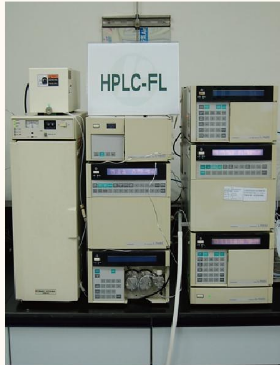
圖三、高效液相層析儀與光化學反應器
